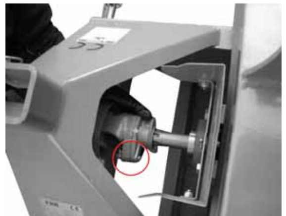
Assemblage de la prise de force
