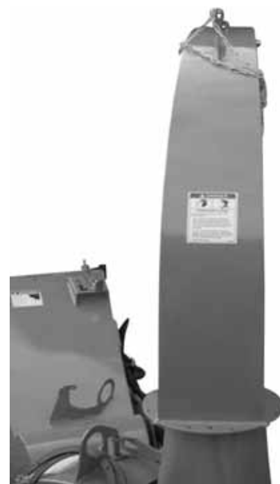
Positionnement de la trémie d'évacuation
