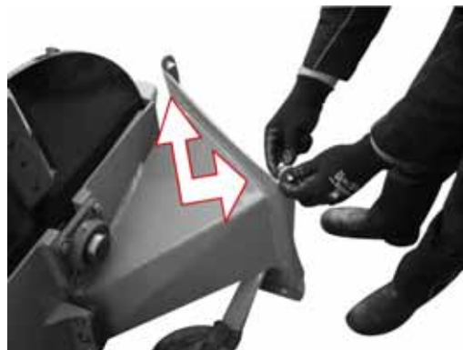
Dépose des vis de la trémie du composant principal
