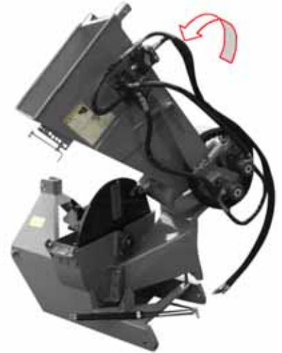
Levage de la trémie d'alimentation à fond
