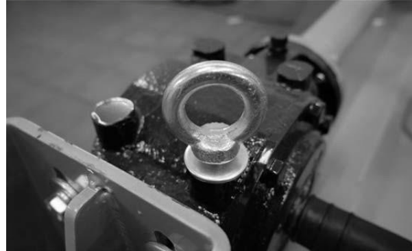
Abb. 42 Hebeöse für Getriebe
