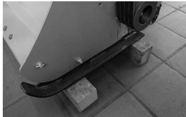
Abb. 10 Aufbocken des Mulchers
