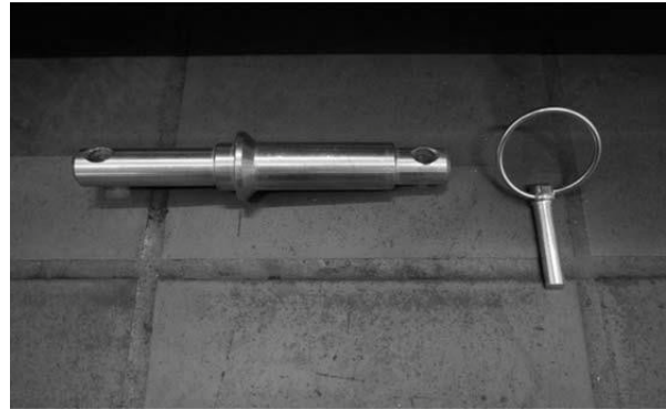
Abb. 39 Wendebolzen mit Sicherungssplint
