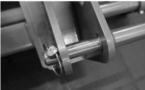
Abb. 40 Wendebolzen in Halterung mit Splint
