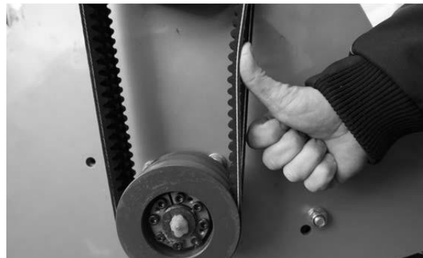
Abb. 26 Korrekte Spannung der Antriebsriemen
