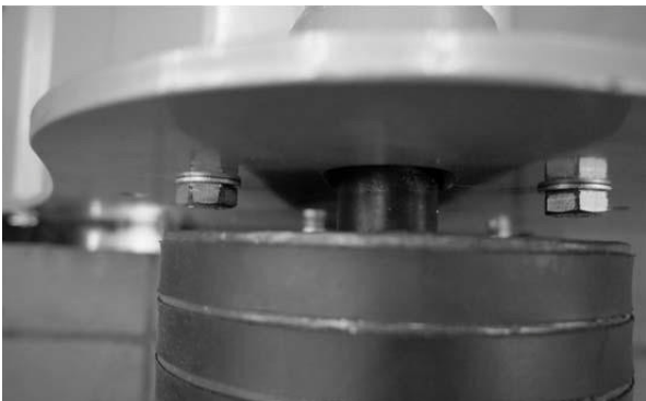
Abb. 25 Korrekter Abstand der Antriebswelle
