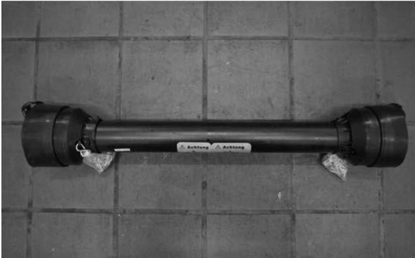
Abb.41 Zapfwelle mit Zapfwellenschutz und Ketten
