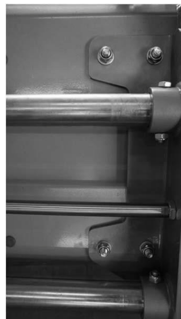
Abb. 15 Befestigte hydraulische Seitenverschiebung (rechte Seite)
