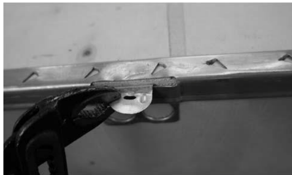
Abb. 4 Öffnen der Verschlusslaschen
